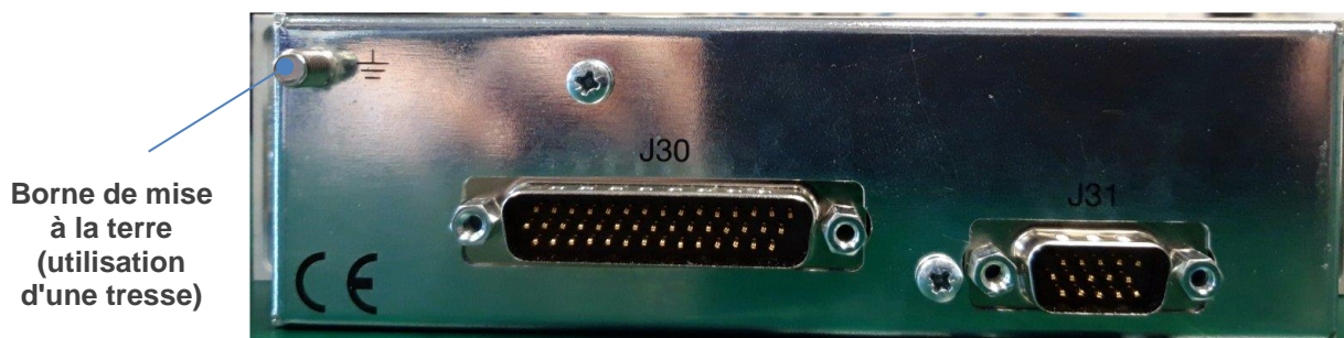
Figure 36 – Interfaces situées au dos de la Face AVant MIAe déportée CATIA
