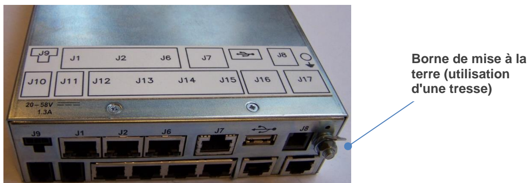
Figure 40 – MIAe NVCS PRO – Repérage des connecteurs de la face arrière
