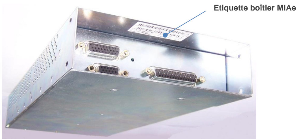
Figure 33 – MIAe – Boîtier côté connexions dédiées à la face avant déportée
