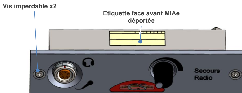
Figure 34 – MIAe NVCS PRO – Présentation de la face avant MIAe déportée
